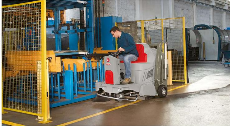
CS700/800 B-H sono spazzatrici uomo a bordo a trazione automatica, disponibili con alimentazione a batterie o con motore a benzina, realizzate nelle versioni da 70 e 80 cm di pista di lavoro (spazzola centrale).
