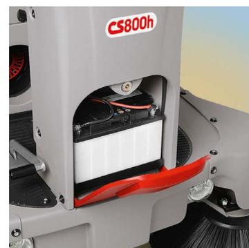
La batteria di avviamento, nelle versioni a motore (CS700-800 H) è collocata nel vano anteriore ed è facile da ispezionare
