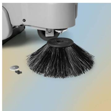
La sostituzione delle spazzole centrale e laterali può essere effettuata senza l'ausilio di utensili
