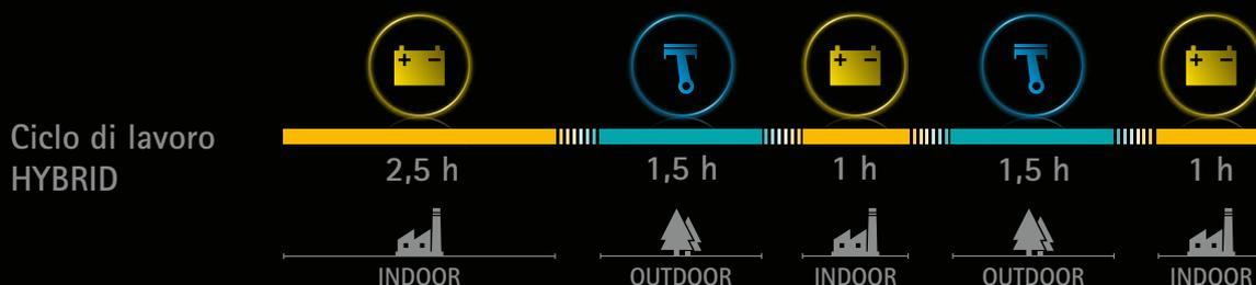
Grazie al sistema di alimentazione combinata Hybrid si può utilizzare FSR sia all'esterno che all'interno, scegliendo l'alimentazione a benzina per gli spazi esterni e privilegiando la silenziosità e l'assenza di emissioni del motore elettrico negli spazi interni.
